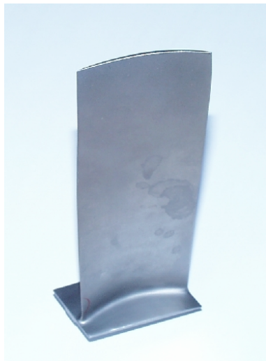
Figura 3.7 – A modelação de uma pá de turbina de gás implica a descrição de superfícies complexas utilizando NURBS (Non-Uniform Rational B-Splines)
